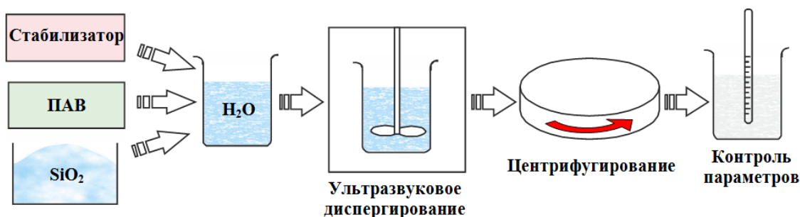
Рисунок 1.2 – Схема получения водных полирующих композиций
